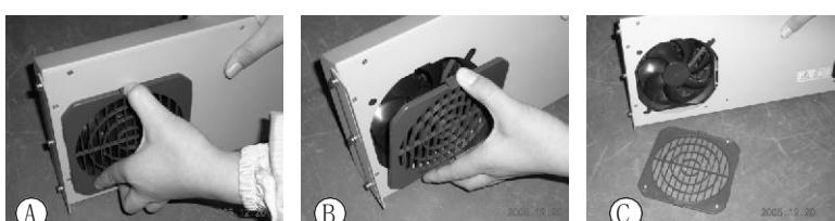
Ⓐ 将塑胶后面罩上部的卡扣向下按住，使卡扣与金属外壳脱离。
